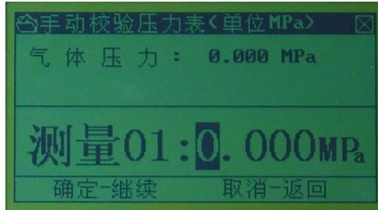
按【◀】、【▶】键, 可以移动光标, 按【+】、【-】键对当前光标所在位置的数值进行修改, 输入当前压力表实际显示压力后, 按【确定】键继续检测下一个压力点。直到所有要检测的压力点全部校验完毕, 系统将显示校验结论:
