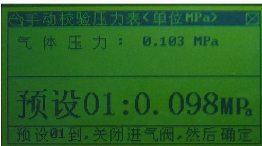
继续给系统缓慢增压，当系统内部压力到达第一个停止压力点（即停止点 01）附近时，蜂鸣器发出“嘀”音提示用户关闭进气阀（此时应手动关闭进气阀），并等待用户输入第一个测量压力点（即压
