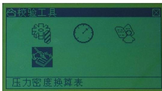
按【▲】、【▼】键让菜单光条落在【压力密度换算】上，按【确定】键后将进入【压力密度换算】界面，如下图所示：
