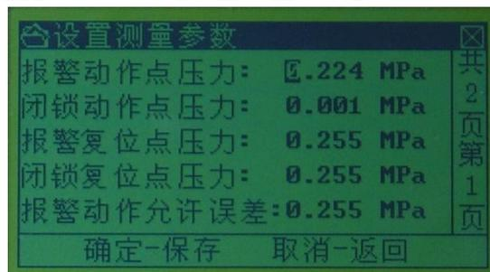
根据密度继电器铭牌，输入被校验密度继电器参数：一般情况报警点动作与复位点值相同，闭锁点动作与复位点值相同，再输入它们允许误差（0.015~0.03MPa）。如果不同密度继电器报警和闭锁值不同时，应及时调整。
